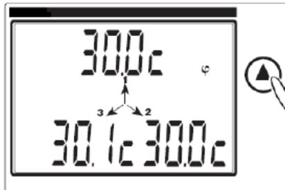
In einem Messbereich von 60° wird der Phasenverschiebungswinkel je Pfad Zwischen Strom und Spannung dargestellt. In der Anzeige kennzeichnet ein „C“ eine kapazitive, ein „L“ eine induktive Phasenverschiebung.
